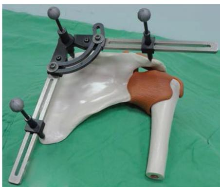
图 1 肩胛骨定位装置的实物图<sup>[11]</sup>
