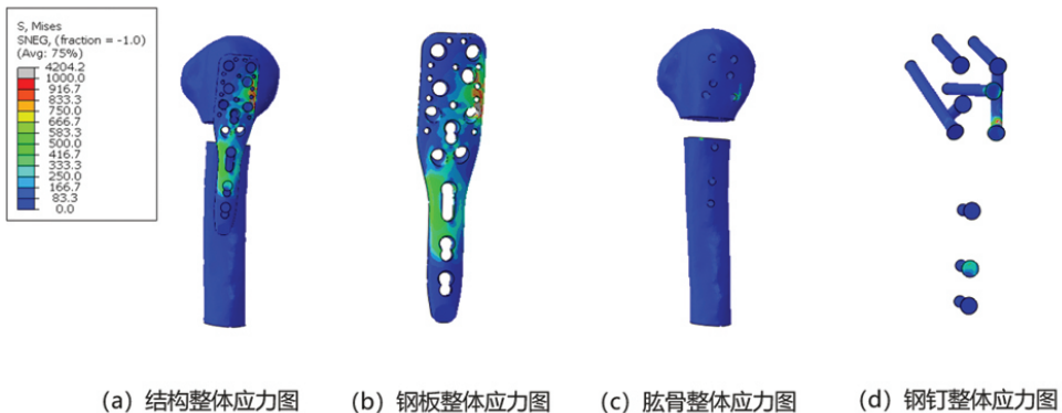
图 8 普通结构的钢板及螺钉应力云图
