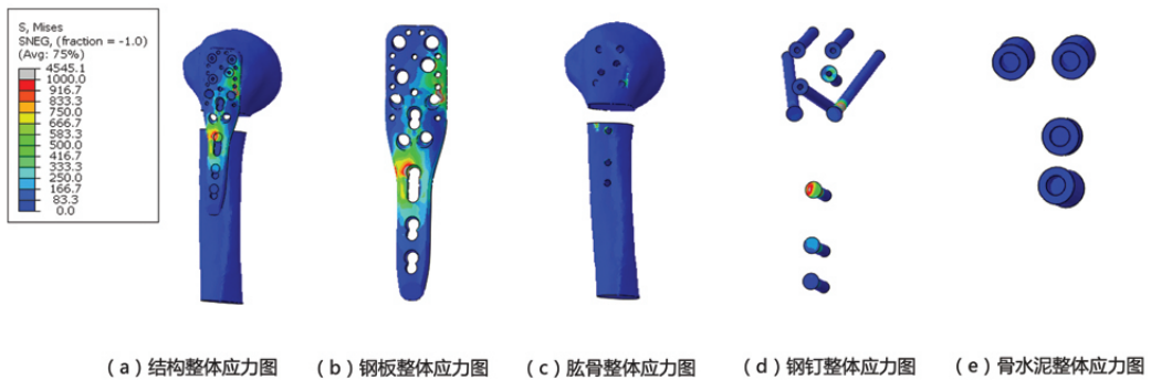
图 7 骨水泥结构的钢板及螺钉应力云图
