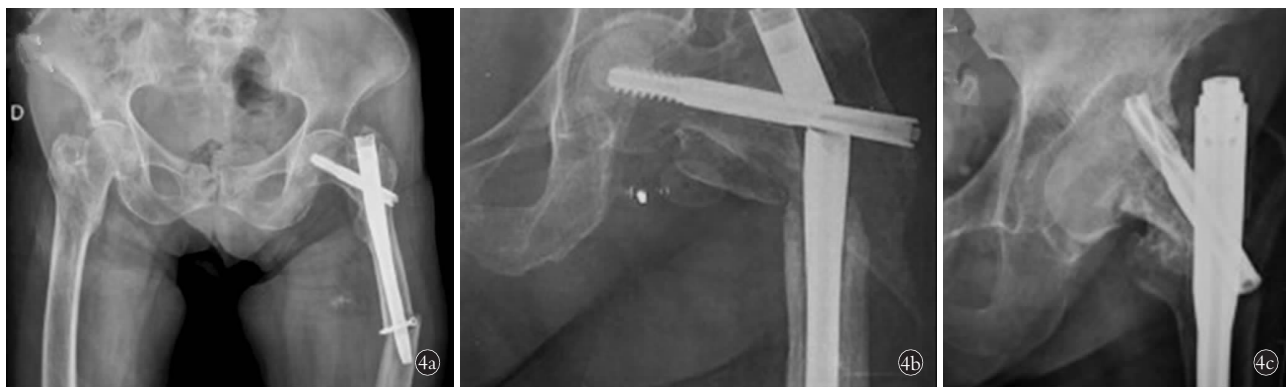
图 4 髓内钉治疗转子间骨折内固定失效 4a. 83 岁老年男性转子间骨折患者术后 8 个月髓内钉远端骨折 4b. 75 岁老年女性转子间骨折患者术后 1 年髓内钉断钉 4c. 77 岁老年女性转子间骨折患者术后 8 个月髓内钉切出
