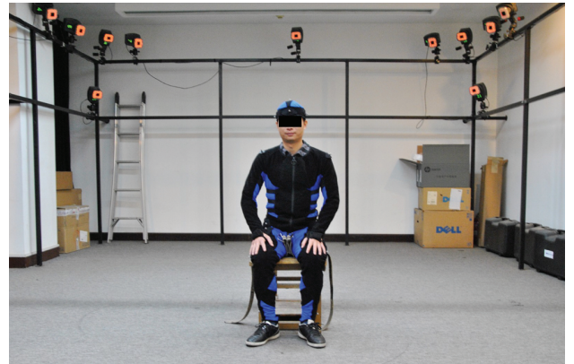
图 1 数字动作捕捉系统操作环境及固定受试者 marker 点
