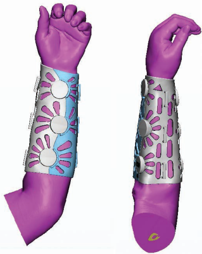
图 2 腕关节支具的 3D 打印模型图 Fig.2 3D printing model of the braces
