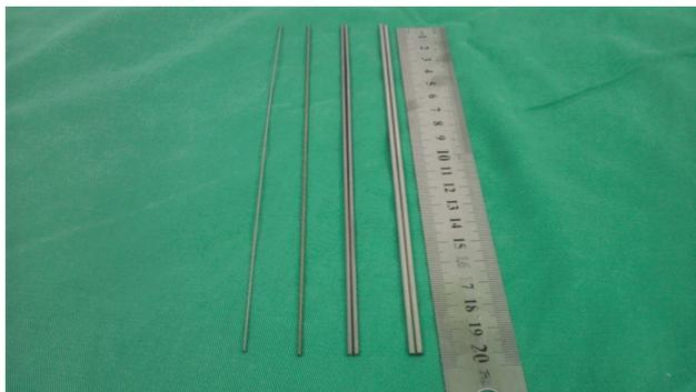
图 1 钢丝导针,材料为不锈钢,长度均为 20 cm,由右到左外径分别为 2.5、2.0、1.5 及 1.0 mm,管壁厚度 0.5 mm
