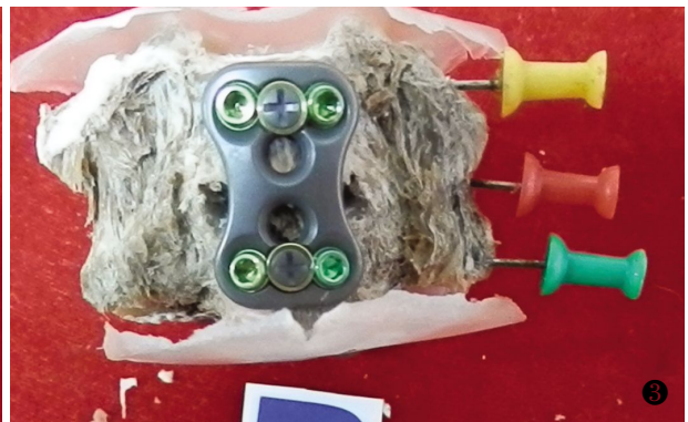
图 2 下颈椎前路椎弓根螺钉配套钢板系统固定 FSU 测试实例图 图 3 普通下颈椎前路椎体螺钉钢板系统固定 FSU 测试实例图 Fig.2 The instance diagram of FSU test anterior transpedicular screw-plate system Fig.3 The instance diagram of FSU test anterior vertebral body screw-plate system
