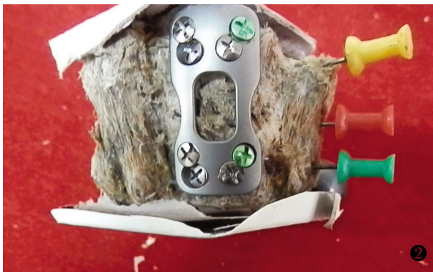
图 2 下颈椎前路椎弓根螺钉配套钢板系统固定 FSU 测试实例图 图 3 普通下颈椎前路椎体螺钉钢板系统固定 FSU 测试实例图 Fig.2 The instance diagram of FSU test anterior transpedicular screw-plate system Fig.3 The instance diagram of FSU test anterior vertebral body screw-plate system
