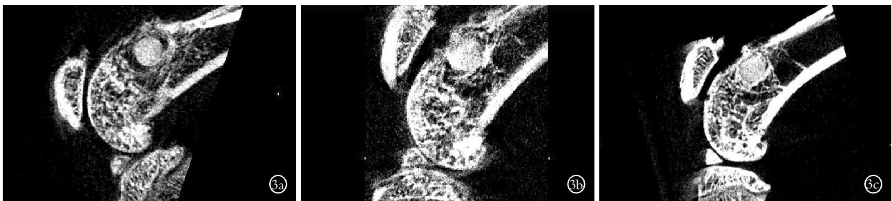
图 3 A 组(MAO-ZK60)大鼠术后 4、8、12 周股骨髁 Micro-CT 图像 3a. 术后 4 周骨-植入体界面有空隙开始形成 3b. 术后 8 周空隙逐渐减小 3c. 术后 12 周时空隙继续减小,植入物与骨质结合较好
