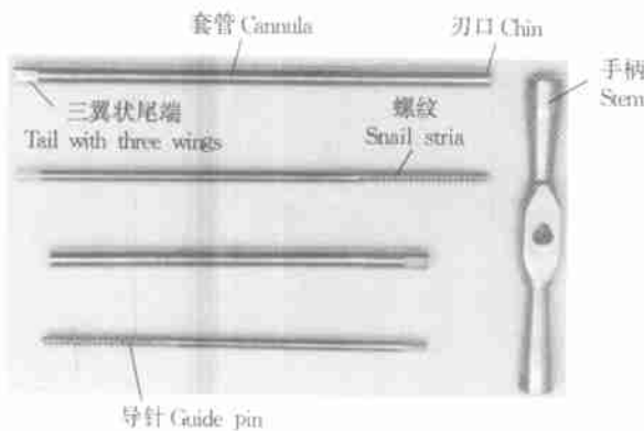
图 1 动力型-螺钉断钉拔出器示意图
