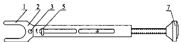
1. 爪钩 2. 固定爪板 3. 爪板固定圆孔 4. 连接活动螺丝 5. 持爪器 6. 加压杆 7. 加压调节器
