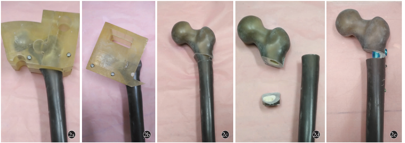
图 2 A3.3 型股骨转子间骨折模型及测试标本制备示意图 2a. 在 3D 打印的截骨模型辅助下, 第 1 刀截骨 2b. 第 2 刀截骨 2c. 截骨线示意图 2d. 骨折模型制作完成后示意图 2e. 骨折模型和髓内钉再组装, 形成测试标本
